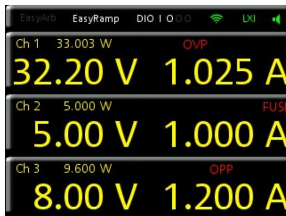
Las funciones de protección ejecutadas se muestran siempre en la pantalla.
