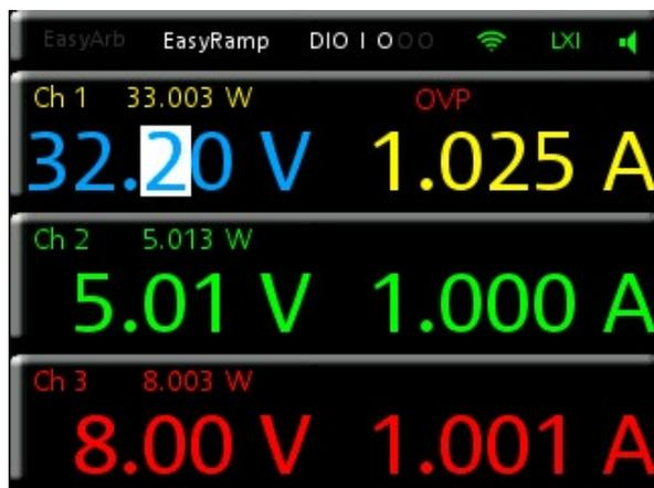
Los diferentes estados de funcionamiento se identifican mediante colores: el funcionamiento con tensión constante se muestra en verde; el funcionamiento con corriente constante, en rojo; los canales inactivos se representan en amarillo; mientras que el azul sirve para indicar que el canal está en modo de ajuste.
