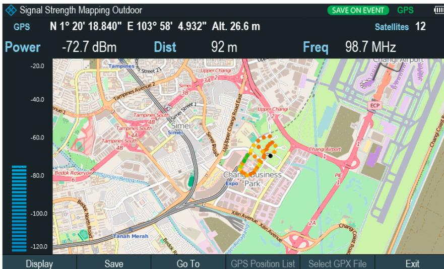
Visualización de la intensidad de la señal interferente en el mapa con la opción de mapeo de intensidad de señal R&S®FPH-K16
