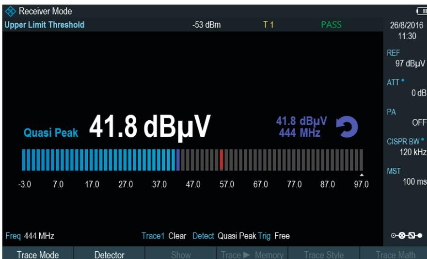
Medición utilizando detectores de cuasi-cresta con la opción de modo receptor R&S®FPH-K43
